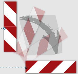
Am Beispiel von Warnmarkierungen für Fahrzeuge mit Sonderrechten: „linksweisend“ in vertikaler Anwendung und um 90° gedreht in horizontaler Anwendung (= rechtsweisend)
