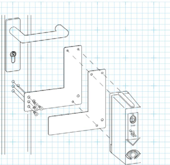
Befestigungsschema eines GfS Einhand-Türwächters für Türklinken an einer Glasrahmentür mit Hilfe einer Montageplatte (Seite 128).
