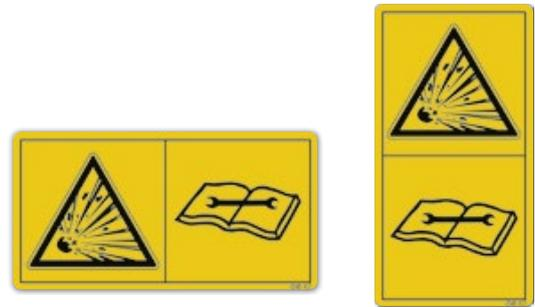
Druckspeicher steht unter Gas- und Öldruck. Ausbau und Reparatur nur nach Anweisung im technischen Handbuch vornehmen.
