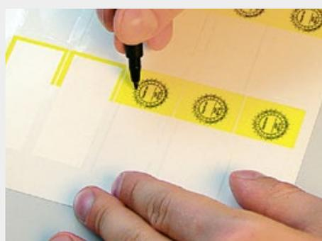
Kennzeichnen Sie den Prüftermin mit einem Faserschreiber (Seite 34) oder einer Lochzange (Seite 35).
