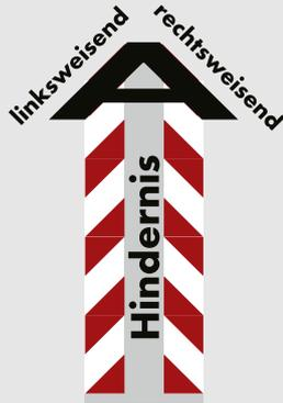
**Achtung:** Die Richtungsweisung des Produktes ändert sich durch Drehung um 90°. Dann liegt eine ursprünglich rechtsweisende Warnmarkierung quer und zeigt linksweisend.
