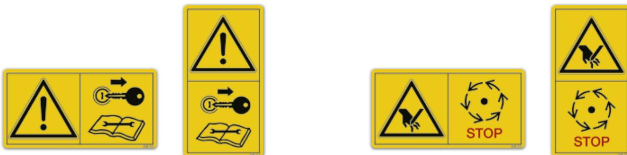
Vor Wartungs- und Reparaturarbeiten Motor abstellen und Schlüssel abziehen.
